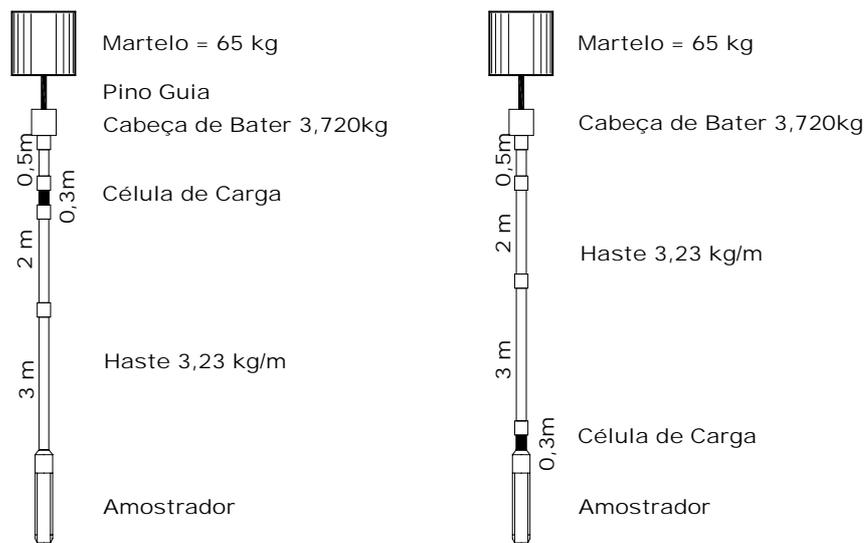
Figura 7.2 – Composição de haste utilizada nos ensaios com haste de 5,80metros.
