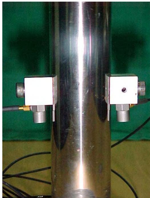
Foto 4.1 – Detalhe de Fixação dos Acelerômetros.
