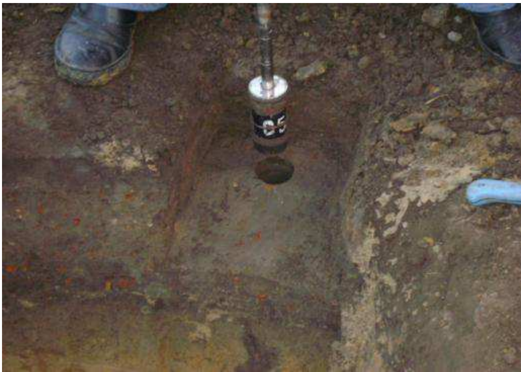
Figura 4.4. Coleta da amostra indeformada nº 05 em trincheira no horizonte A.
