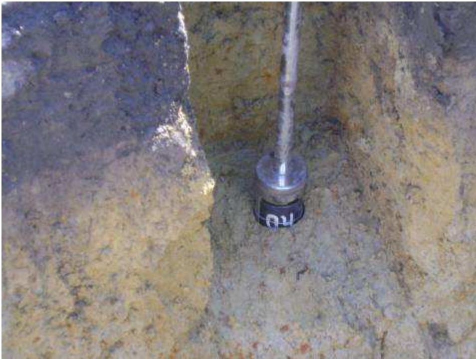
Figura 4.5. Coleta da amostra indeformada nº 04 em trincheira no horizonte B.
