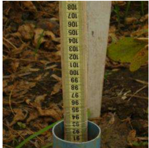
Figura 4.16. Detalhe da leitura do nível do lençol com a régua inserida no poço.
