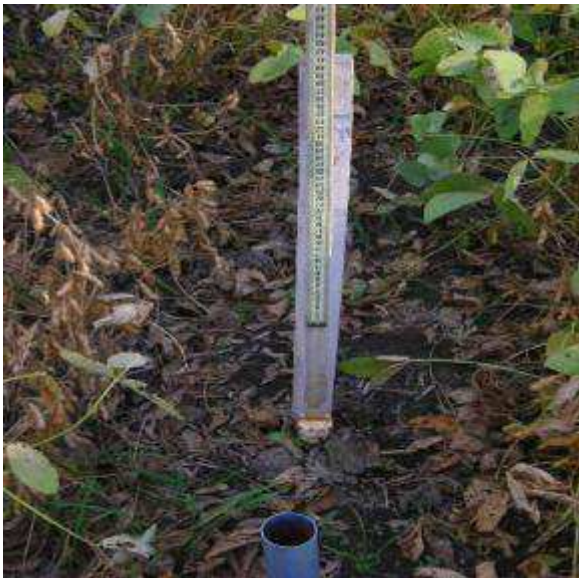
Figura 4.15. Detalhe da régua graduada e calibrada com bóia na extremidade.
