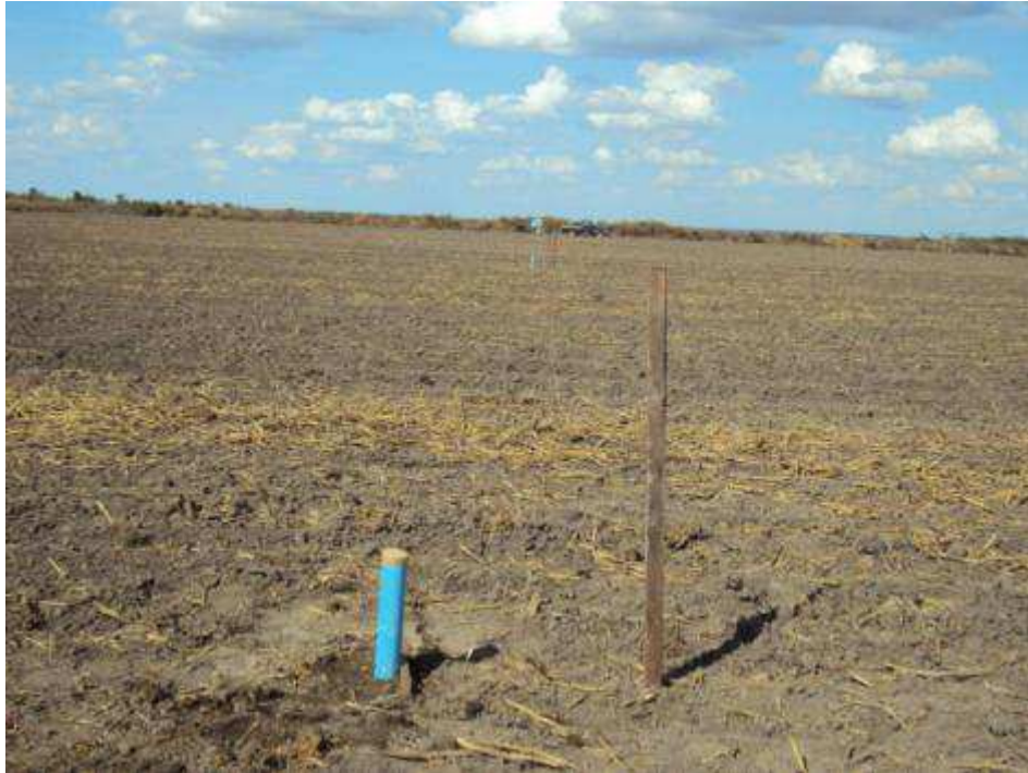
Figura 4.6. Poços de observação recém instalados na parcela.
