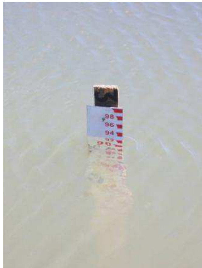
Figura 4.10. Leitura da régua nº 3 instalada no KK a oeste da parcela.
