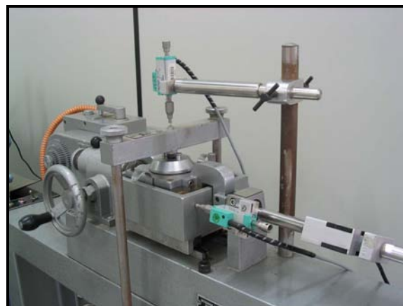
Foto 3.4: Detalhe da célula de cisalhamento e instrumentação
