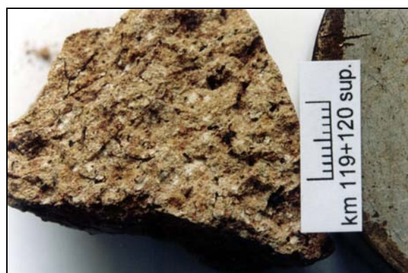
Foto 5.6: Textura do solo km 119+120 superior (seco – escala de 1 cm)
