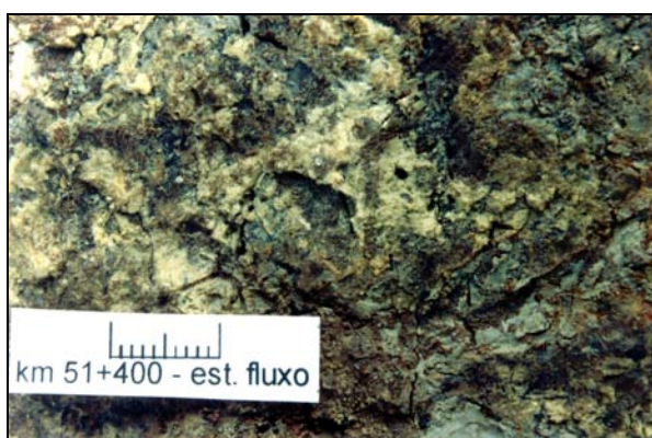
Foto 6.7: Textura do solo km 51+400 Riodacito – foto A (escala de 1 cm)
