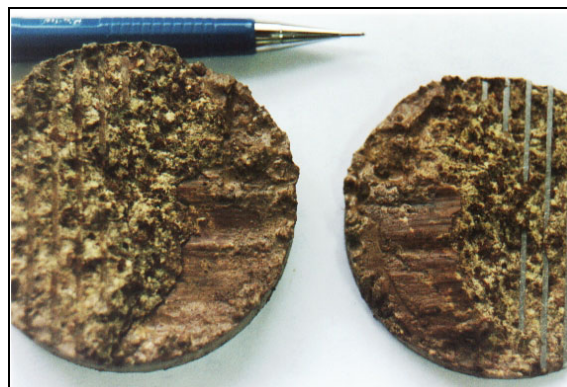
Foto 4.19: Aspecto da superfície de cisalhamento do solo Teutônia no ensaio CDRM com \sigma'_n=200 kPa
