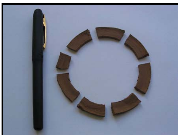
Foto 3.8: Amostras retiradas da célula de cisalhamento do ensaio ring shear para análise no MEV
