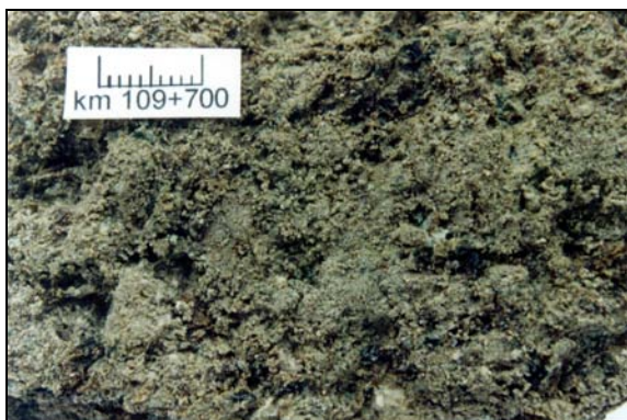
Foto 5.13: Textura do solo km 109+700 (úmido – escala de 1 cm)
