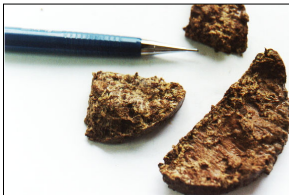
Foto 4.18: Aspecto da superfície de cisalhamento do solo Teutônia no ensaio CDRM com \sigma'_n=50 kPa
