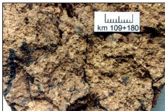
Foto 5.12: Textura do solo km 109+180 (seco – escala de 1 cm)
