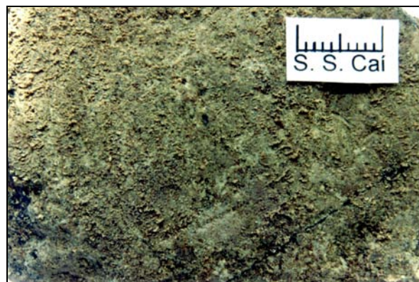
Foto 5.2: Textura do solo SSCaí (úmido - escala de 1 cm)
