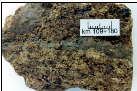
Foto 5.11: Textura do solo km 109+180 (úmido – escala de 1 cm)
