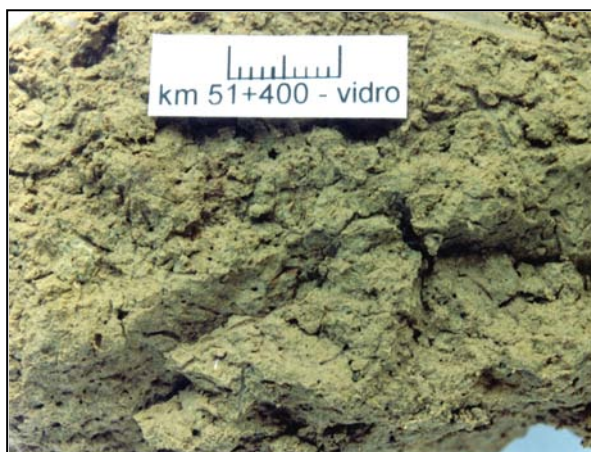
Foto 6.10: Textura do solo km 51+400 Dacito (escala de 1 cm)
