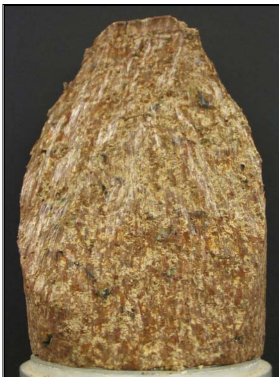
Foto 4.30: Aspecto liso, estriado e reflexivo da superfície de cisalhamento formada no ensaio triaxial CID com \sigma'_c = 400 kPa, indicando a orientação de partículas de argila
