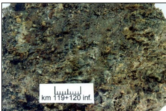
Foto 5.7: Textura do solo km 119+120 inferior (úmido – escala de 1 cm)
