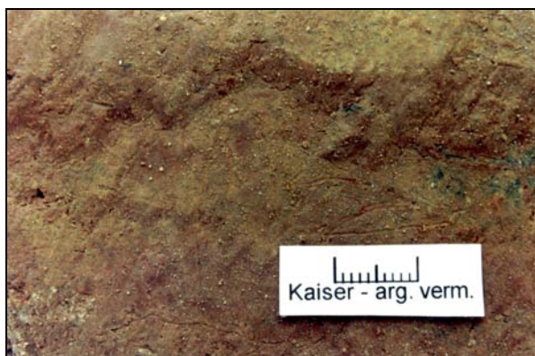
Foto 6.5: Textura do solo Kaiser AV no plano de ruptura (escala de 1 cm)
