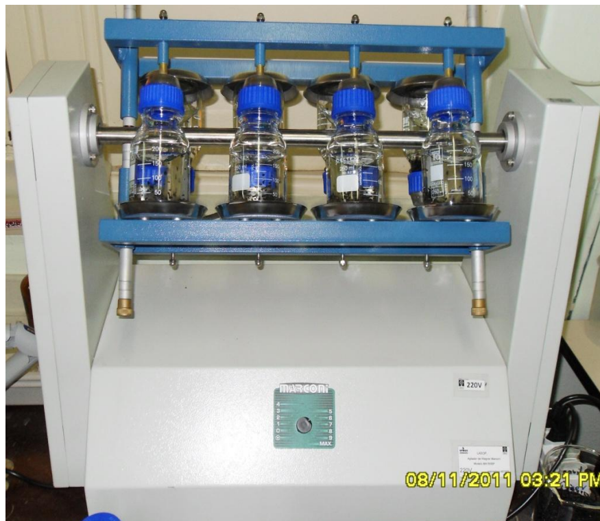
Figura 2.2. Fotografia do Agitador de Wagner utilizado nos processos de sorção e dessorção.
