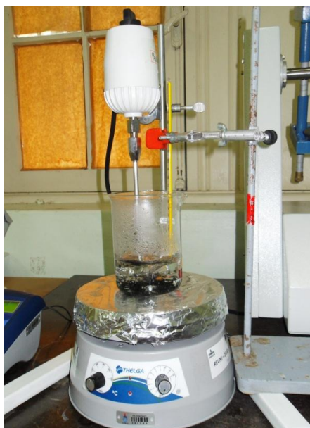
Figura 2.3. Fotografia do aparato experimental utilizado para processo de dessorção com H 2 O 60°C.
