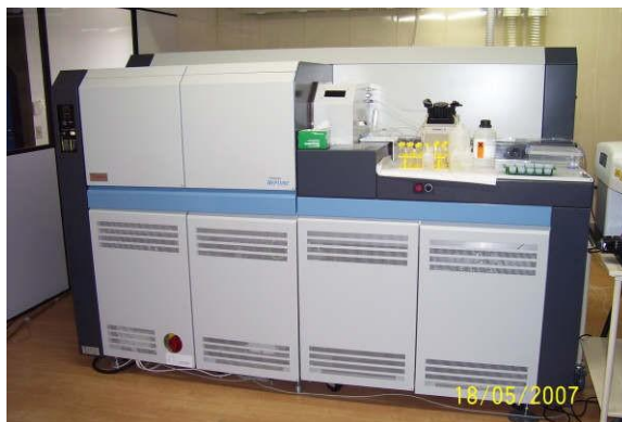
Figura 11 - ICP-MS do Laboratório de Geologia Isotópica do CPGq – IG/UFRGS.
