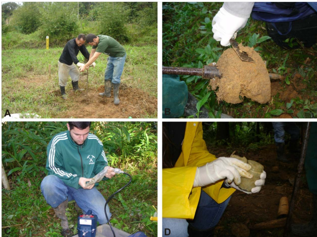
Figura 6. (A) Amostragem de solo com trado manual; (B) limpeza da parte superficial do material antes da coleta da amostra; (C) medição de VOC na amostra de solo acondicionada em ziplock; (D) preenchimento dos frascos para análise.
