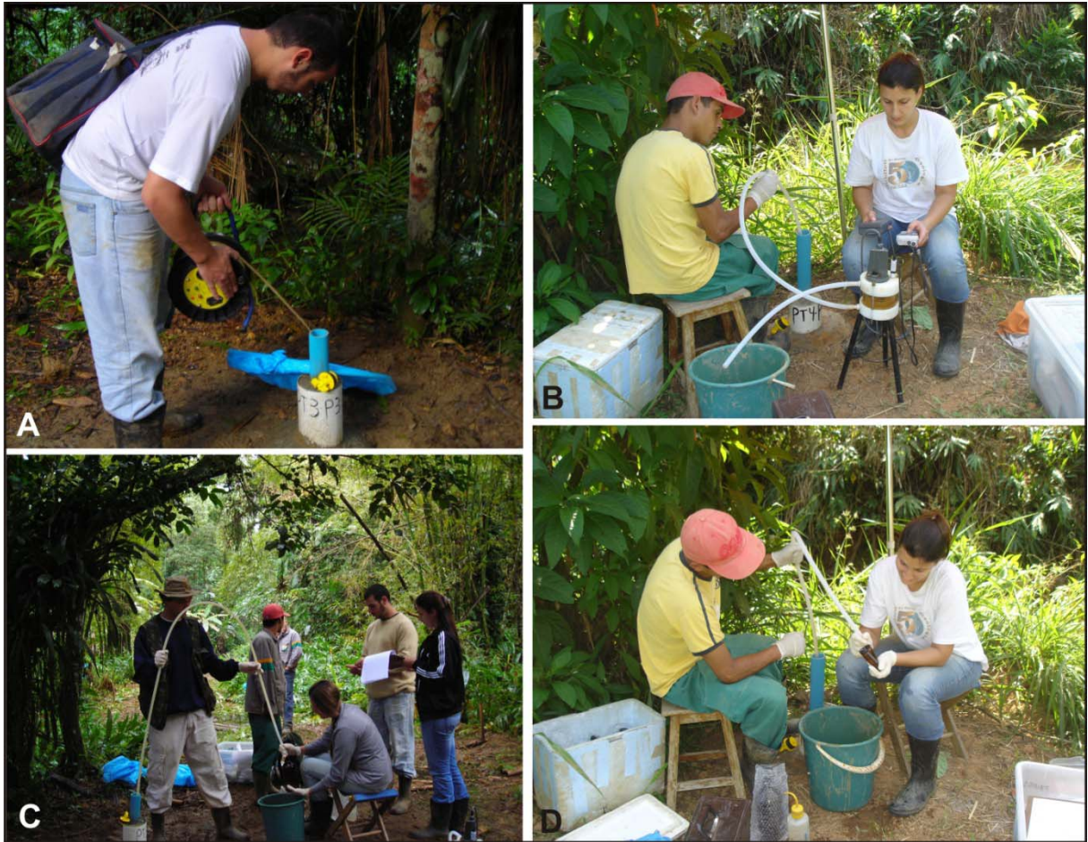
Figura 8. Procedimentos da amostragem da água subterrânea. (A) Medição do nível d'água. (B) Utilização da célula de fluxo para medição dos parâmetros físico-químicos: a água retirada do poço pelo sistema de bombeamento WATERRA penetra na célula pela sua parte inferior e sai pelo tubo superior, sendo descartada em balde graduado; o HORIBA (cinza) e o eletrodo ORP, acoplados na parte superior da célula, efetuam as medições dos parâmetros da água dentro da célula. (C) Purgagem do poço. (D) Coleta de amostra para análise de BTEX (frasco de 40mL).
