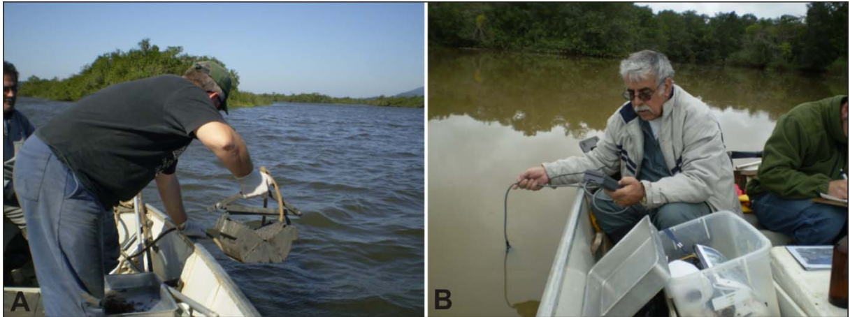
Figura 21. Amostragem de sedimento (A) e medição dos parâmetros físico-químicos da água no rio do Neves (B).
