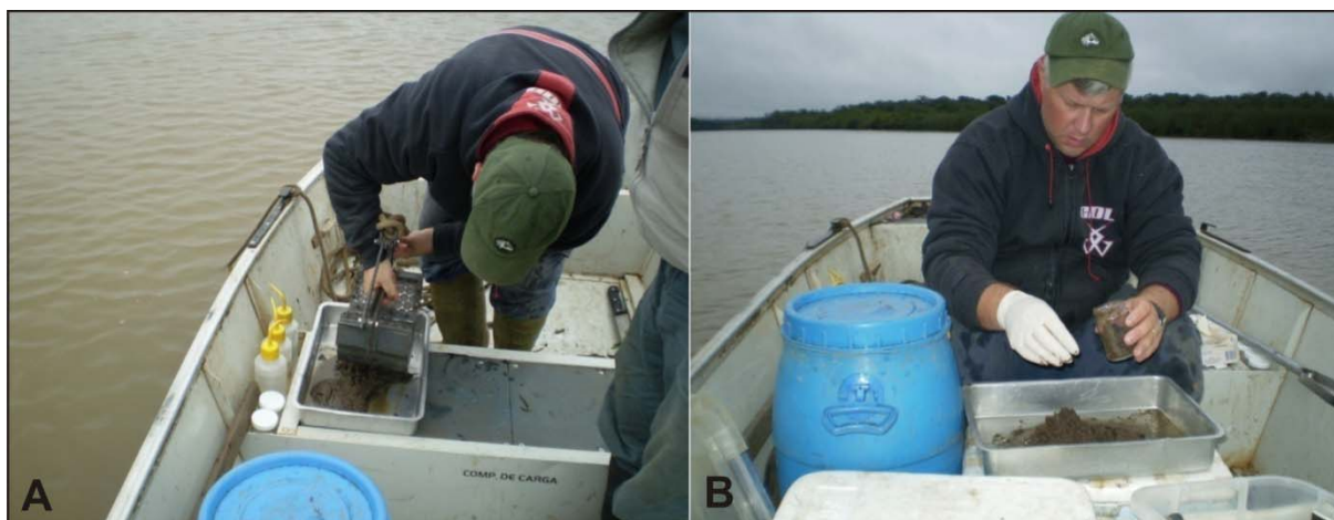
Figura 10. (A) Amostragem de sedimento de fundo com draga Van-Vin, transferência do sedimento para bandeja metálica. (B) Acondicionamento do sedimento de fundo no frasco para remessa ao laboratório. A bombona azul é utilizada para acondicionar os produtos químicos utilizados para limpeza dos equipamentos e ferramentas, até serem entregues à PETROBRAS para destinação final.
