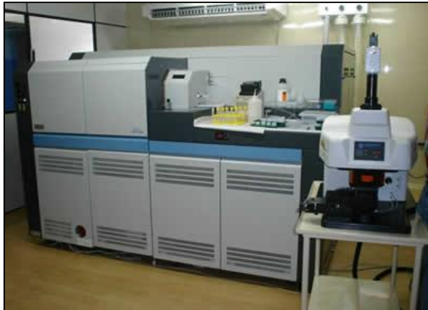
Figura 1 – Ilustração do MC-ICP-MS Neptune (ThermoFinnigan) com a microsonda a laser UP213 (New Wave) acoplada, utilizados para as análises in situ de U-Pb em zircão no LGI-UFRGS.
