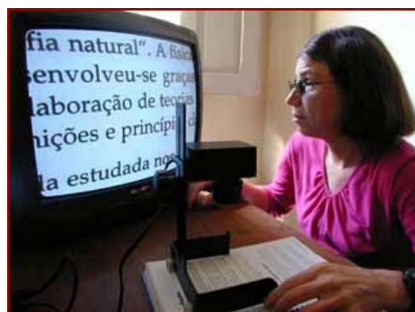
Figura 6 - Circuito Fechado de Televisão Fonte: http://www.pr.gov.br/cap/equipamentos.html
