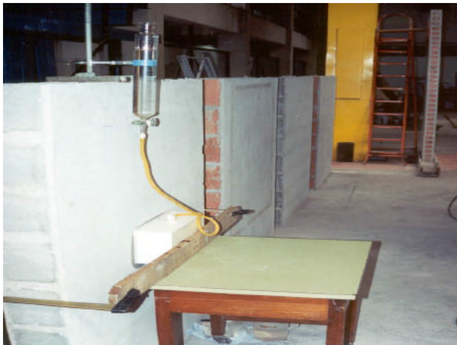
Figura 29: ensaio de permeabilidade - método do IPT
