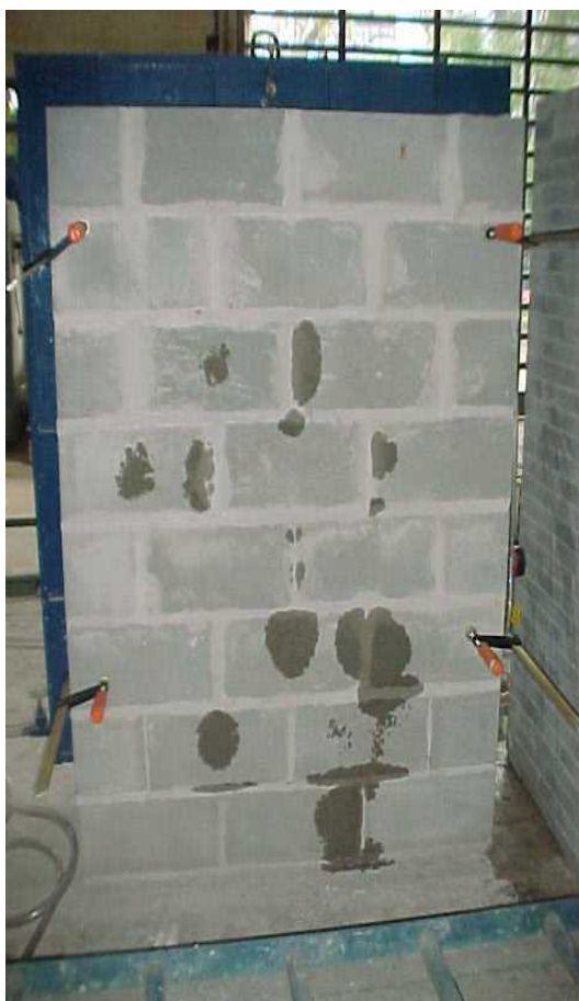
Figura 50: ensaio de absorção de água pelo método empregado pela CIENTEC - bloco de concreto - corpo de prova 1 - tempo de ensaio: anterior a 5 minutos da 1 a . etapa
