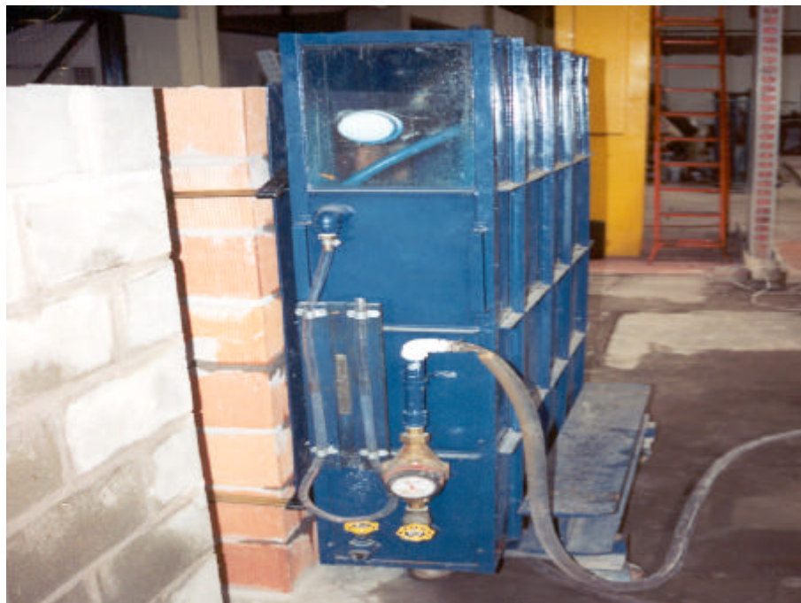
Figura 31: câmara para ensaio de permeabilidade de paredes – método da CIENTEC
