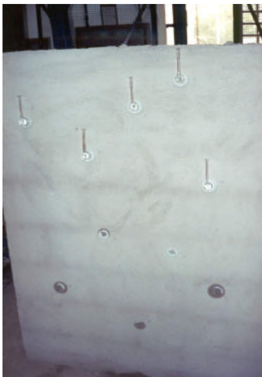
Figura 27: avaliação de estanqueidade pelo método do cachimbo – vista frontal
