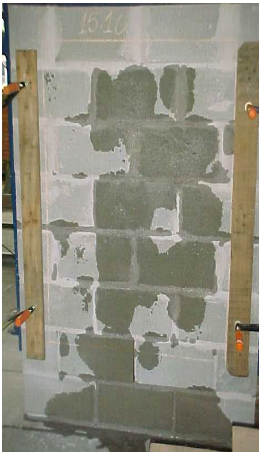
Figura 52: ensaio de absorção de água pelo método empregado pela CIENTEC - bloco de concreto - corpo de prova 5 - tempo de ensaio: 5 minutos da 1ª. etapa
