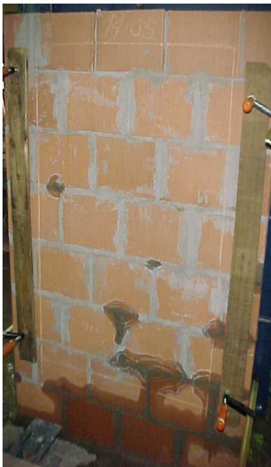
Figura 46: ensaio de absorção de água pelo método empregado pela CIENTEC - bloco cerâmico - corpo de prova 4 - tempo de ensaio: 120 minutos da 1 a . etapa
