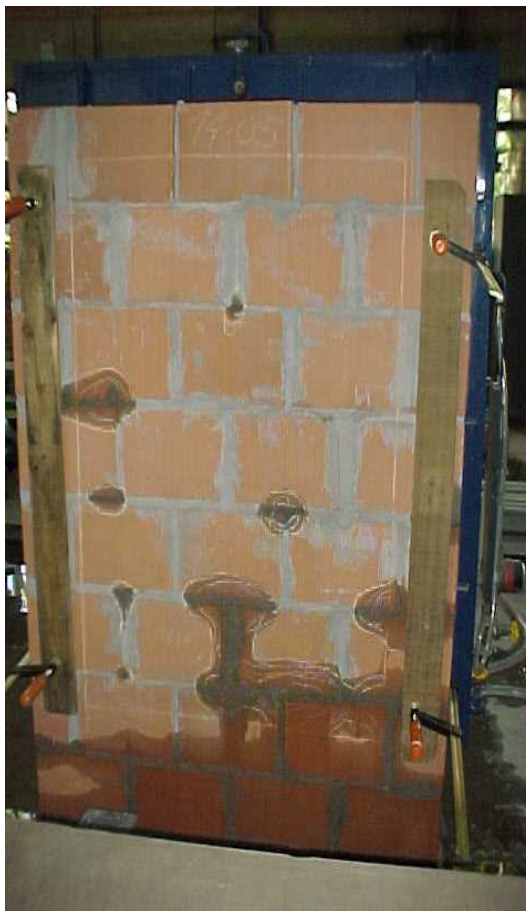
Figura 47: ensaio de absorção de água pelo método empregado pela CIENTEC - bloco cerâmico - corpo de prova 4 - tempo de ensaio: 15 minutos da 2 a . etapa
