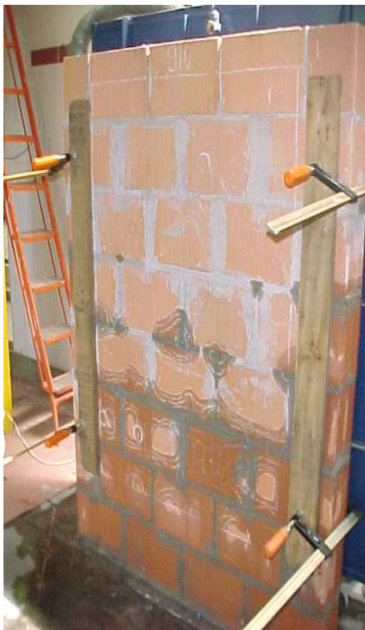
Figura 49: ensaio de absorção de água pelo método empregado pela CIENTEC - bloco cerâmico - corpo de prova 6 - tempo de ensaio: 150 minutos da 1ª. etapa
