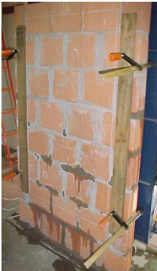
Figura 48: ensaio de absorção de água pelo método empregado pela CIENTEC - bloco cerâmico - corpo de prova 6 - tempo de ensaio: 15 minutos da 1 a . etapa
