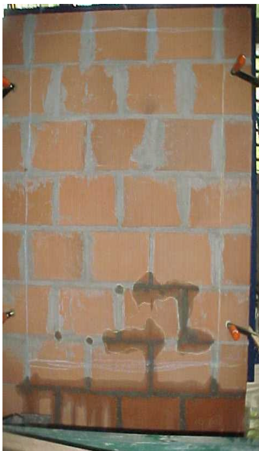
Figura 44: ensaio de absorção de água pelo método empregado pela CIENTEC - bloco cerâmico - corpo de prova 2 - tempo de ensaio: 90 minutos da 1 a . etapa
