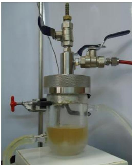
Figura 46. Reator utilizado nas reações de oligomerização e nas reações de polimerização.
