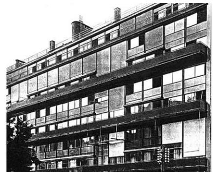
57- Edifício Clarté, Le Corbusier, 1930-32, Genebra, Suíça. Vista externa mostrando parte da fachada longitudinal. A coincidência do plano de fachada com a linha de pilares periféricos é atenuada pelos balcões contínuos, que retomam a estratificação horizontal oferecida pela planta livre.
