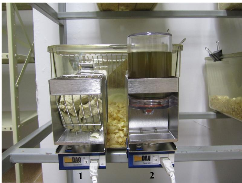
**Figura 2 – Detalhe do sistema de registro BioDAQ®: consumo de ração (1) e bebida (2)**
