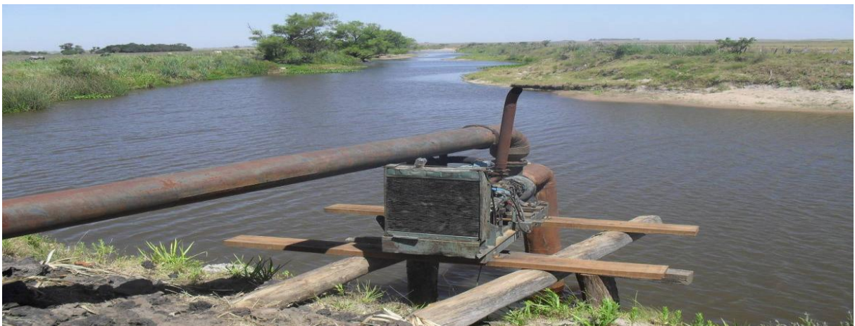
Bomba de sucção utilizada na irrigação – Estância “B”. Fotografia: Valeriano Alan Jardim de Moraes (autor).
