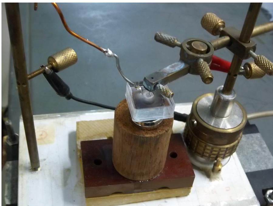
Figura 4.5: Foto do sistema experimental do método *drop-off* magnético.
