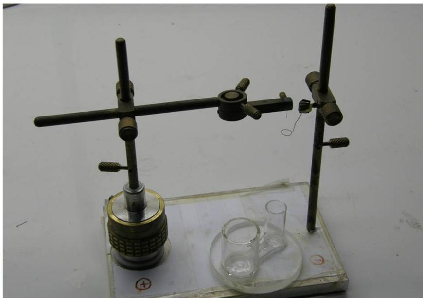
Figura 4.2: Foto do aparato utilizado para a fabricação das nanoponteiras.
