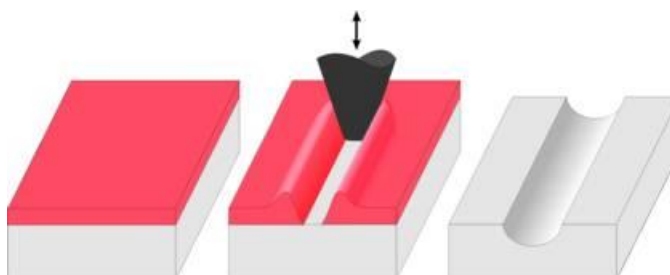
Figura 2.5 – Desenho esquemático do processo de criação de padrões em nanoescala por modificações induzidas mecanicamente.
