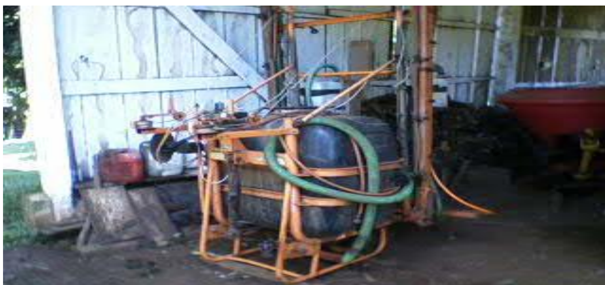
Figura 15. Pulverizador mecanizado Fonte. Arquivo pessoal, novembro de 2010
