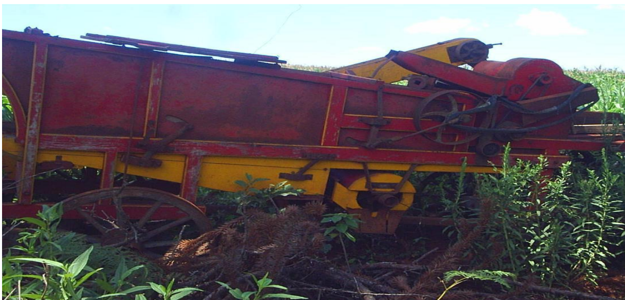
Figura 07. Trilhadeira, máquina tocada a motor a gasolina
