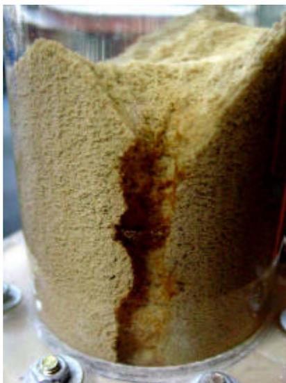
Figura 48. Caminho preferencial (*bypass*) e zonas mortas – Leito fixo de flocos de zeólita natural.  $m: 200 \text{ g}$ ; FLONEX 9045:  $4 \text{ mg}\cdot\text{g}^{-1}$ ;  $Q: 1,2 \text{ L}\cdot\text{min}^{-1}$ .
