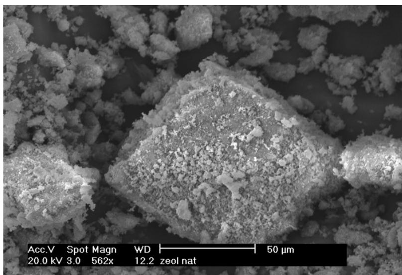
Figura 14. Imagem (MEV) de um grão de zeólita natural. O comprimento da barra (escala) equivale a 50 µm e a magnificação é de 562X.
