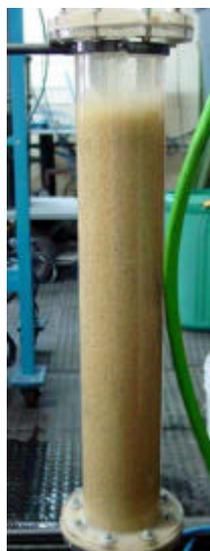
Figura 49. Leito expandido/fluidizado de flocos de zeólita natural.  $m: 200 \text{ g}$ ; FLONEX 9045:  $4 \text{ mg}\cdot\text{g}^{-1}$ ;  $Q: 5 \text{ L}\cdot\text{min}^{-1}$ .
