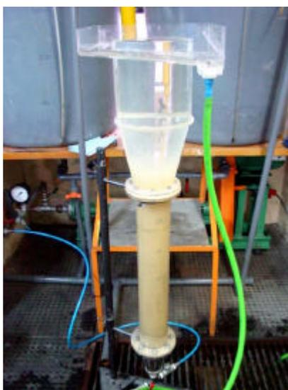
Figura 3. Reator de leito expandido/fluidizado.
