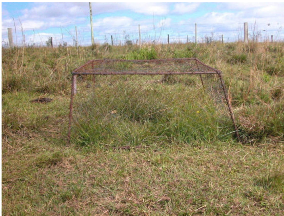
Figura 6. Gaiola utilizada para proporcionar exclusão ao pastejo. A gaiola foi fixada de maneira que a distância entre os dois marcadores do ponto amostral correspondeu à diagonal do quadrado formado pelos limites da gaiola.
