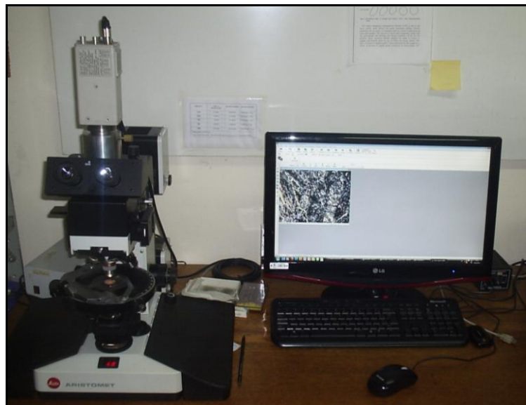
Figura 12 - Foto do microscópio Leitz Wetzlar modelo ARISTOMET – 553428, com câmera acoplada ao computador.
