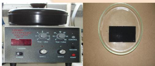
Figura 2. a) Spin Coater; b) placa de aço inoxidável AISI 304 revestido com filme de PAni
