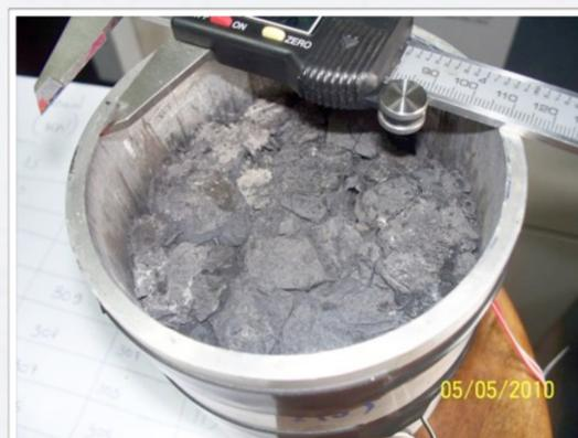
Foto 2 Célula de compactação, com rejeito de carvão no interior, após a compactação.
