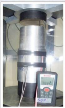
Foto 1 Célula de compactação em alumínio, com strain gauges, sendo carregada verticalmente.
