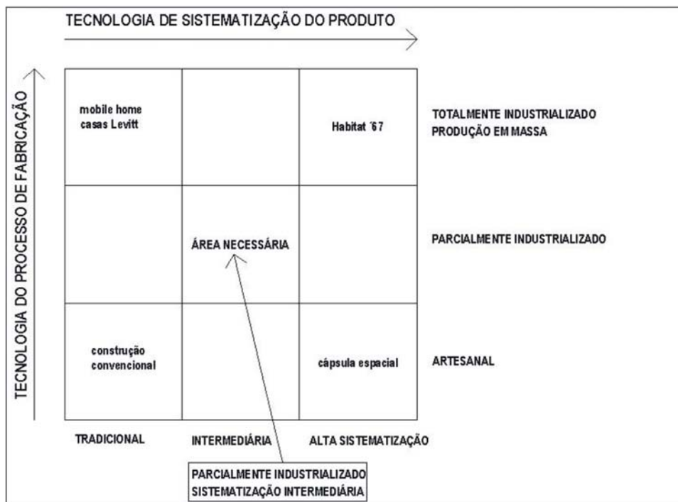
Figura 4: Processo de fabricação comparado com a sistematização do produto (TERNER; TURNER, 1972 apud DUARTE, 1982)
