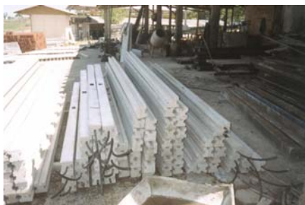
Figura 11: Pilares com eletrodutos embutidos
