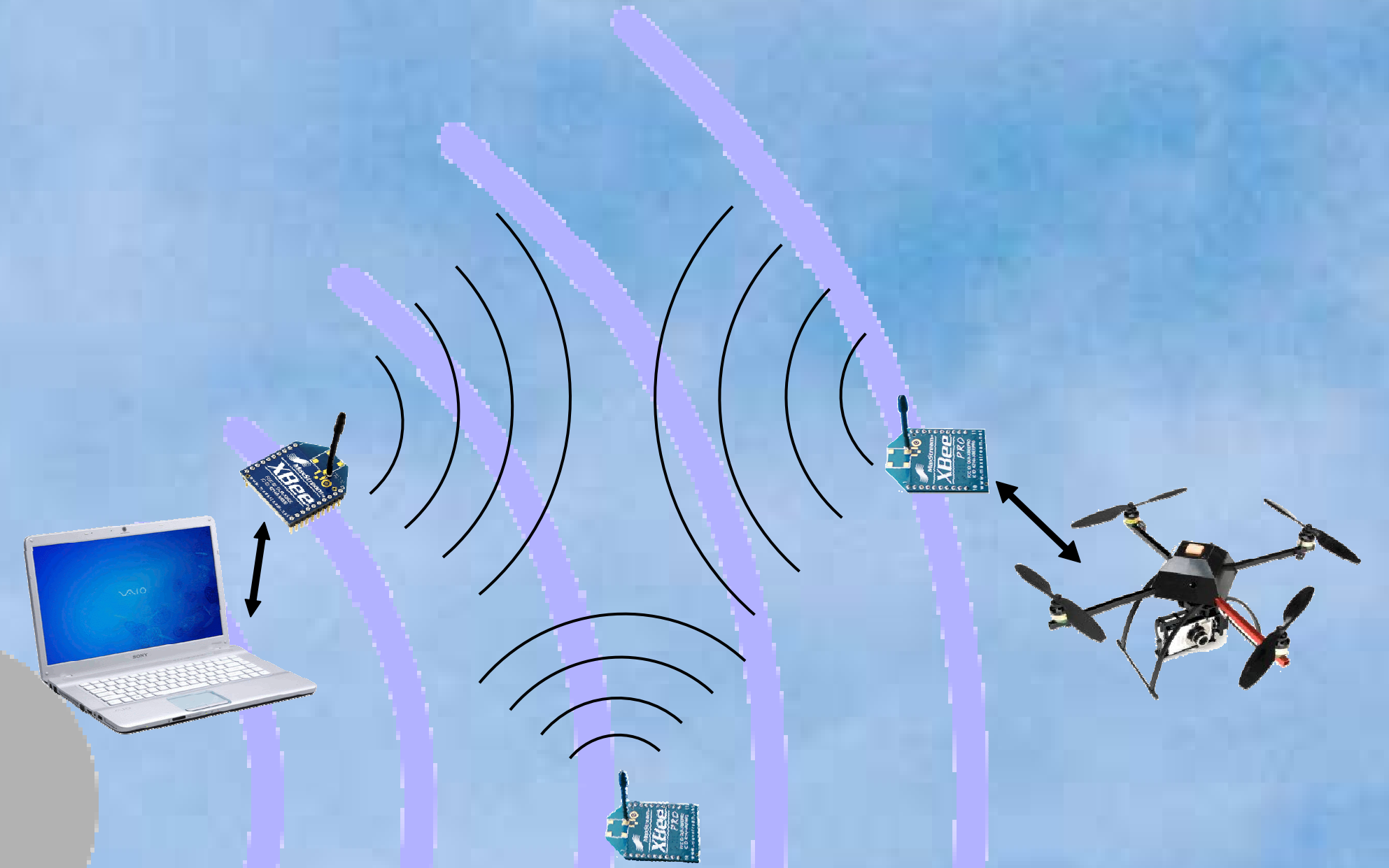
Figura 3. Comunicação dos dispositivos da rede por radiofrequência
