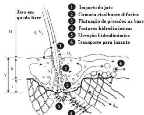
Principais parâmetros e processos físico-mecânicos na formação de fossas de erosão (adaptado de Bollaert e Schleiss, 2003).
