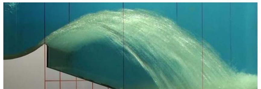
Modelo em escala 1:50 no Laboratório de Hidráulica Experimental e Recursos Hídricos - LAHE/FURNAS
