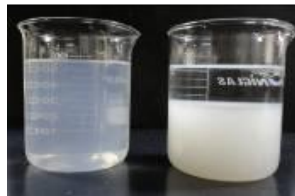
Figura 5.a) Fotografia dos precipitados de alumínio gerados a pH 4,5 em água deionizada (esquerda) e solução com íons sulfato (direita). Tempo de sedimentação 120 minutos.
