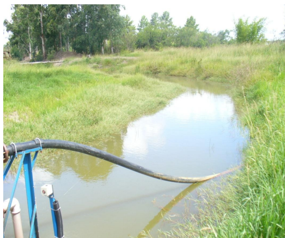
1. a) Detalhes da bacia de efluentes neutros gerados pelo despejo de água do "lavador" de carvão na Mina do Recreio e b) Unidade de tratamento por PF-Sedimentação lamelar, 1 m^3 \cdot h^{-1} .
