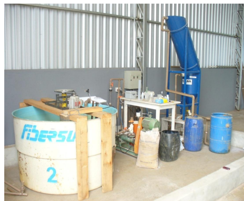
1. a) Detalhes da bacia de efluentes neutros gerados pelo despejo de água do "lavador" de carvão na Mina do Recreio e b) Unidade de tratamento por PF-Sedimentação lamelar, 1 m^3 \cdot h^{-1} .
