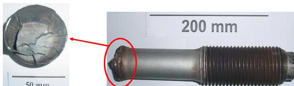
Figura 2 e 3: Imagem do componente recebido para análise, e à direita imagem indentificando a superfície da fratura.
