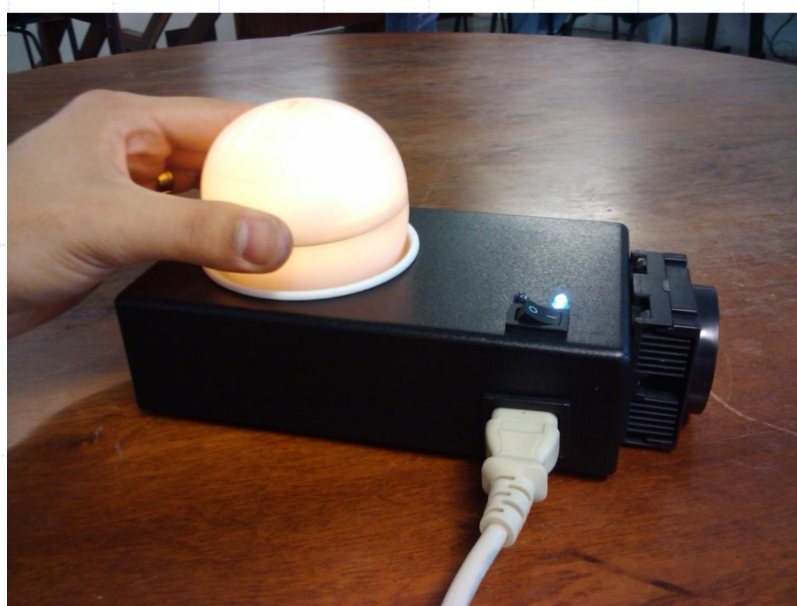
Figura 1 – Sistema de recarga de bateria sem fio, com bobina primária na base e secundária no interior da esfera instrumentada.
