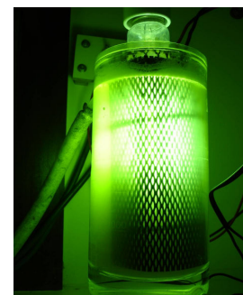
Figura 2: Fotorreator utilizado nos ensaios de FEO. Onde (1) reator de vidro encamisado. (2) Ânodo. (3) Cátodo. (4) Tubo de quartzo. (5) Lâmpada de vapor de mercúrio. As setas indicam a entrada e a saída do banho termostático.
