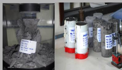
Figura 3 - Corpos de prova usados no teste uniaxial.
