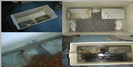
Figura 1 - Simulação de galerias para granito e carvão.
