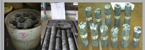
Figura 4 - Corpos de prova usados no teste triaxial.
