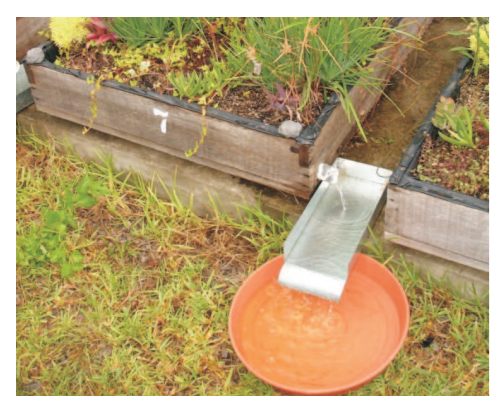
Figura 5: Teste de escoamento e retenção de água. Canteiro Experimental - FAU-PUCRS. Fonte: USE
