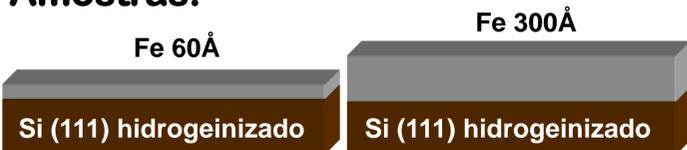
Os filmes foram fabricados utilizando-se a técnica de deposição *sputtering*.
