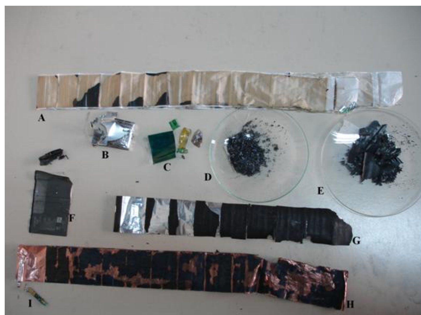
Figura 1. Componentes de uma bateria de íons de lítio: A - Separador; B - Blindagem metálica; C - Fitas adesivas; D - Material ativo do cátodo; E - Material ativo do ânodo; F - Carcaça externa; G - Coletor de carga do cátodo; H - Coletor de carga do ânodo; I - PCI's.
