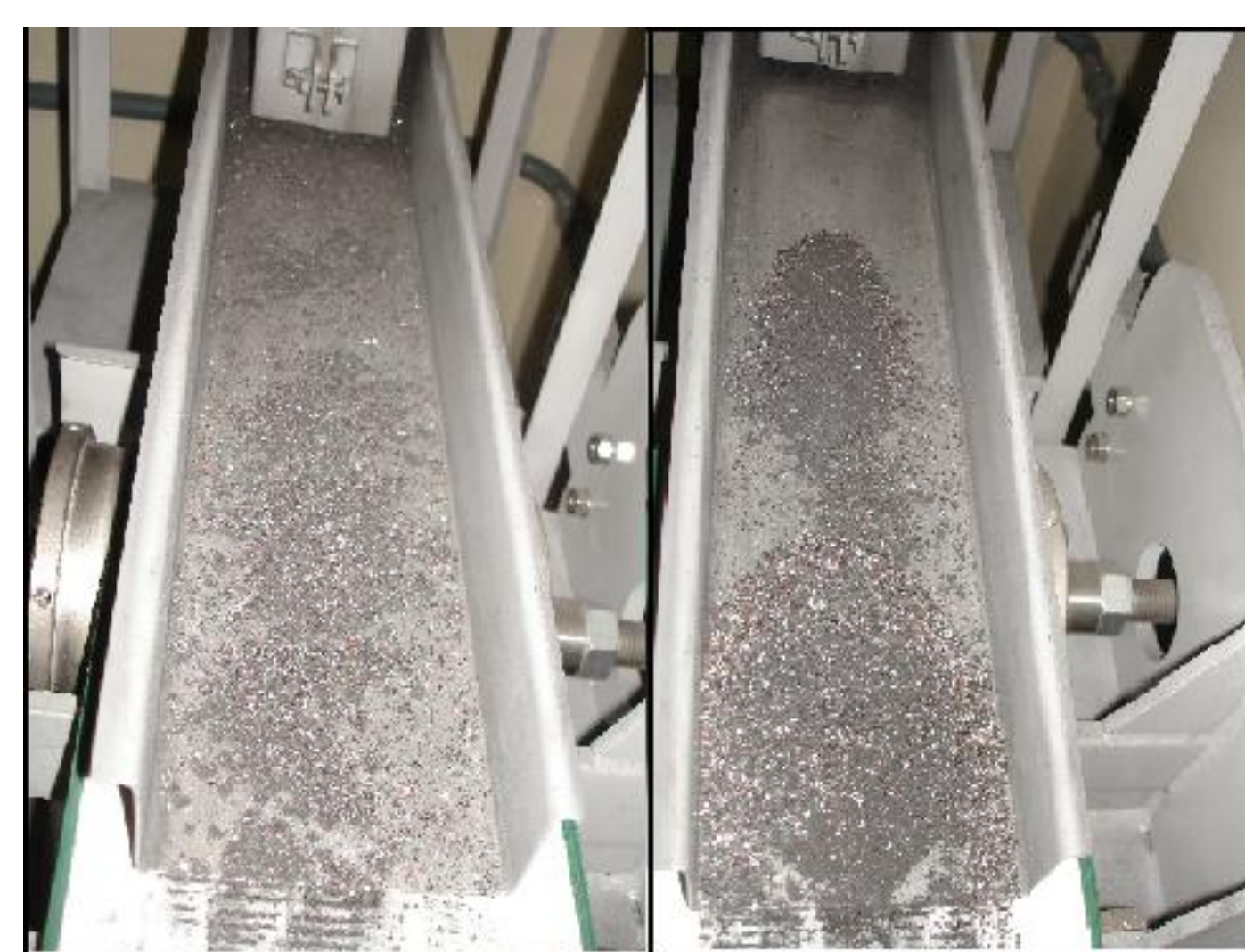
Figura 4. Distribuição das partículas na esteira vibratória do separador magnético com taxas de alimentação de 10g/min (esquerda) e 50g/min (direita).
