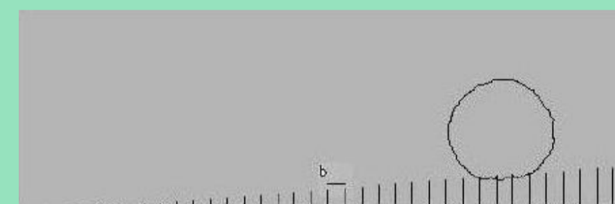
A Gota sobre a superfície estruturada, onde b é a separação entre os pilares.
