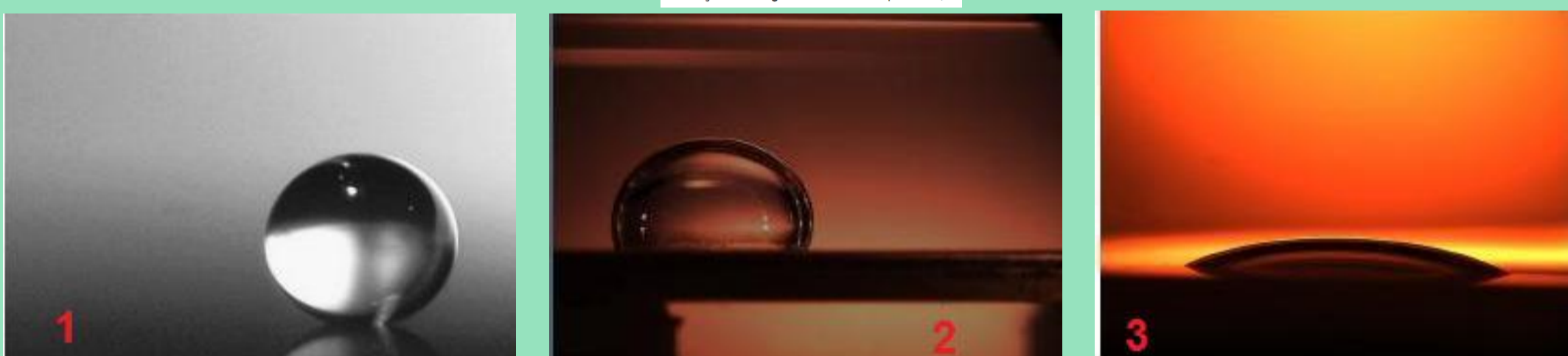
Figuras: 1- Superfície superhidrofóbica: \theta \geq 150^\circ , 2- Superfície hidrofóbica: 90^\circ \leq \theta < 150^\circ , 3- superfície hidrofílica: \theta < 90^\circ
