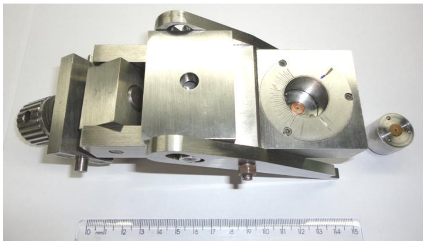
Figura 1: DAC utilizada nos experimentos. As bigornas de diamante estão no centro dos anéis de cobre. Um deles fixo no interior da DAC e o outro à direita, no hemisfério móvel do equipamento, o qual é colocado por cima ao fechar a DAC.
