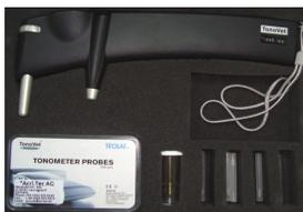
Figura 1 - Tonômetro de rebote.
