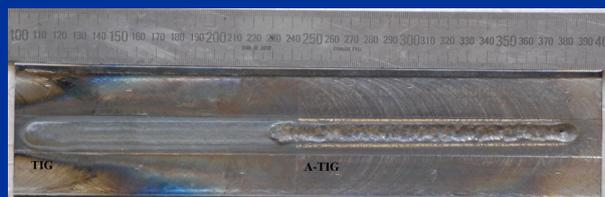
Fig.4: Superfície do corpo de prova soldado com o Fluxo TiO<sub>2</sub> (rutilo). Percebe-se uma piora na aparência superficial na região A-TIG.
