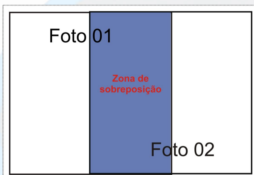
Fig. 1. Sobreposição mínima necessária de 50% entre duas fotos.
