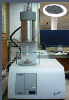
Figura 1. Termobalança utilizada nos ensaios de gaseificação e cadinho com a amostra.
