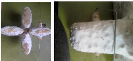
Figura 2: a) Molde cerâmico em fase de preparação para o vazamento. b) Detalhe da posição dos termopares.
