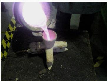
Figura 5: Fotografia do momento do vazamento em um dos moldes.
