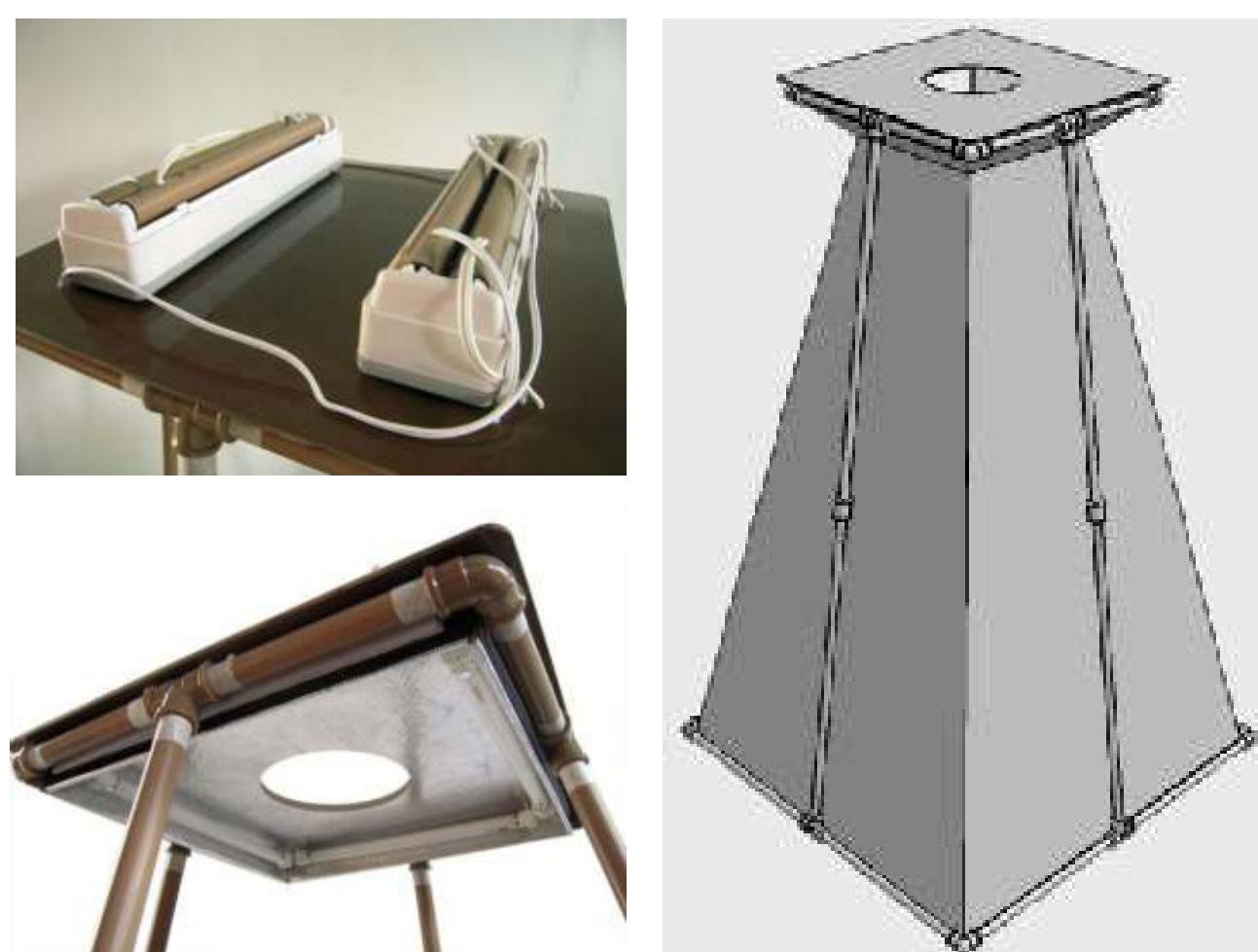
equipamento desenvolvido para a fotografia de superfícies ortogonais à objetiva da câmera (não contém a câmera)
