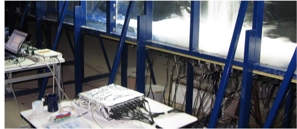
Equipamentos para medição de pressão por transdutores
