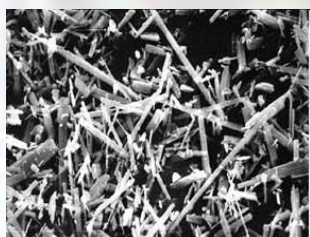
Figura 2 - Fibras de wollastonita vista ao microscópio eletrônico de varredura
