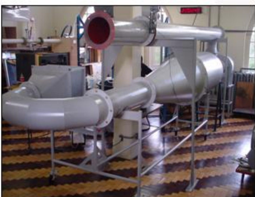
Figura 1: bancada de testes de filtros de acordo com a norma EN 779:2002
