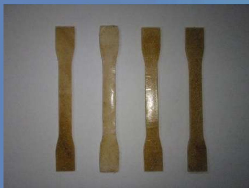
Figura 1: Corpos de prova em forma de gravata utilizados nos testes de tração.
