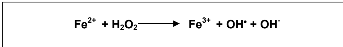
Figura 7. Produção do radical hidroxila através da Reação de Fenton.
