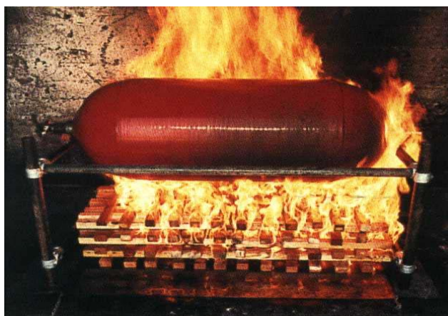
Figura 6 Teste de resistência ao fogo dos cilindros de GNC
