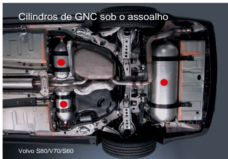
Figura 3 Disposição de cilindros em veículo vindo de fábrica a GNC (1)
