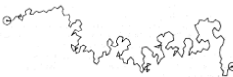
Fig. 2.1: Arranjo aleatório de uma cadeia polimérica de polietileno.
