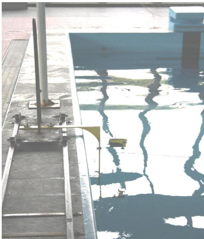
**Figura 1** – Carrinho, trilhos e suporte para as câmeras externa e subaquática.
