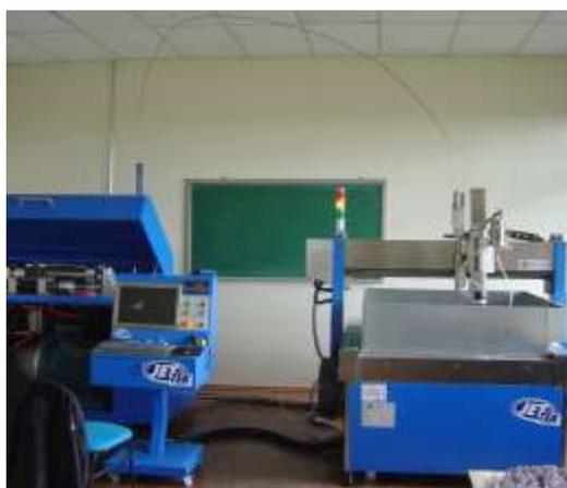
Figura 50: Equipamento de usinagem por jato de água, marca Jet Tek WaterJet<sup>®</sup>.
