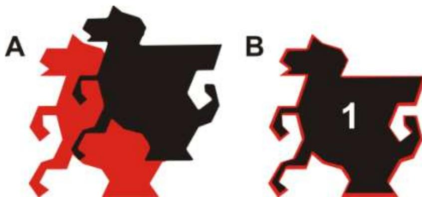
Figura 68: (A) O desenho original encontra-se na cor vermelha e a digitalização da peça 1 encontra-se na cor preta; (B) Na sobreposição a borda em vermelho equivale à perda de material.
