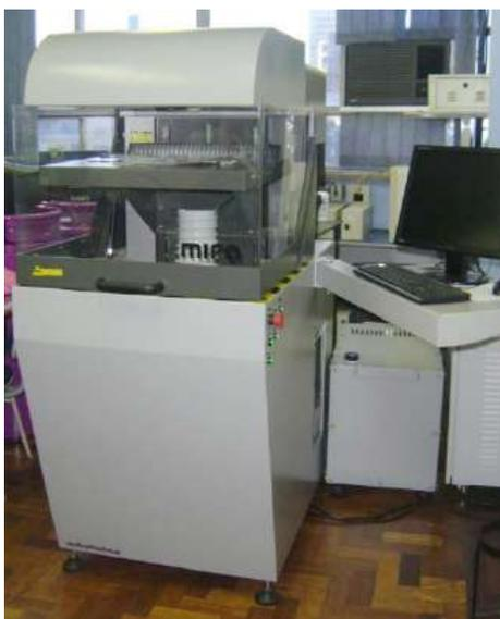
Figura 54: Equipamento de corte a laser, marca Automatisa<sup>®</sup>, modelo Mira.
