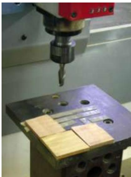
Figura 71: Usinagem dos corpos de prova.
