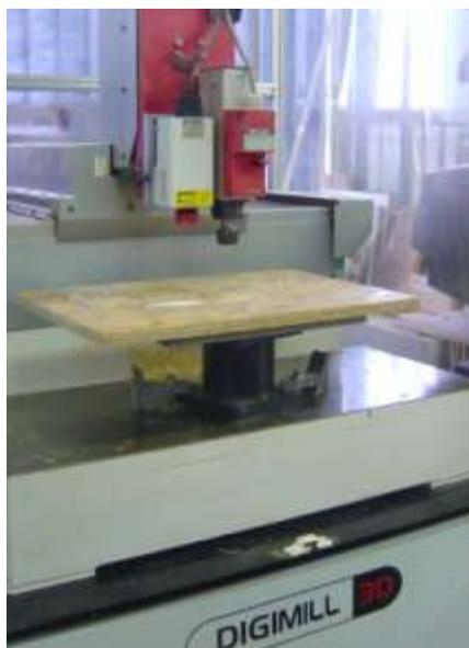
Figura 52: Equipamento de usinagem CNC, marca Tecnodrill<sup>®</sup>, modelo Digimill 3D.
